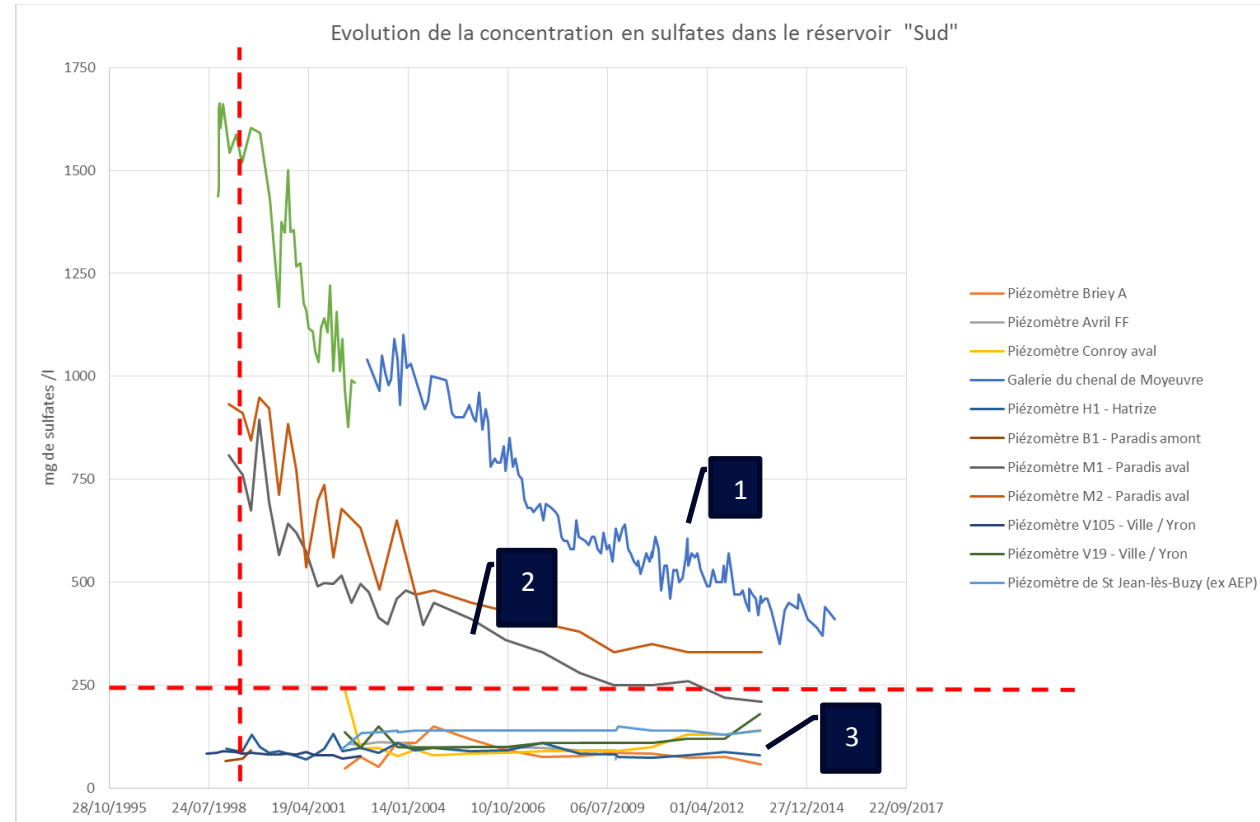
Figure 54 : Evolution des teneurs en sulfates dans le réservoir Sud (source : données ADES)
