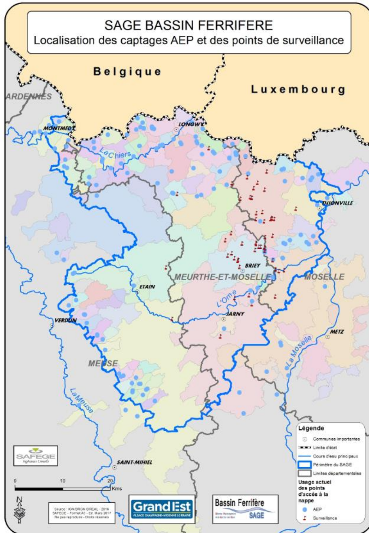
Figure 10 : Localisation des points de captages et des points de surveillance des eaux souterraines
